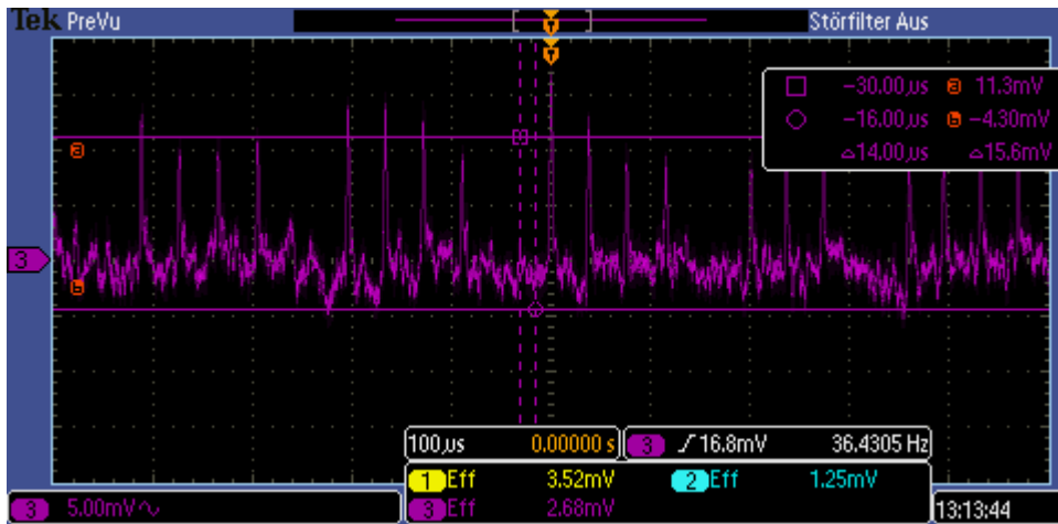
Abbildung 5.3: Messsignal U_{AT} mit EIko C entspricht 47\mu F
