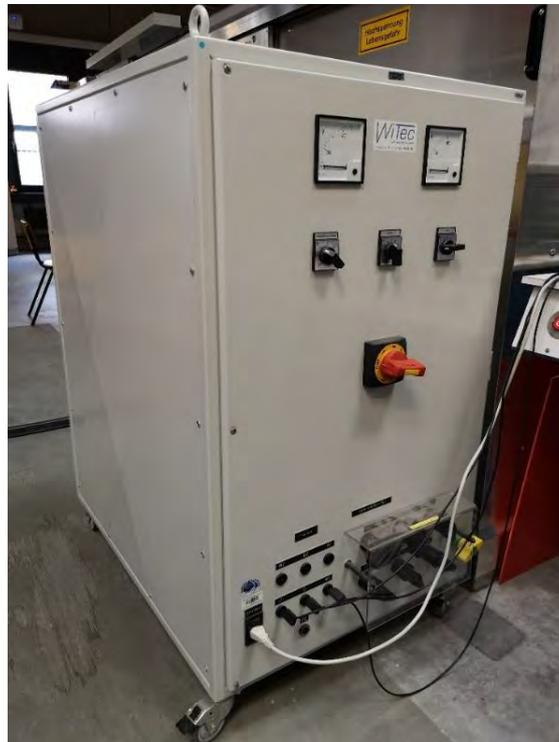
Abbildung 14: Dreiphasiger Lastwiderstand mit 3 kW
