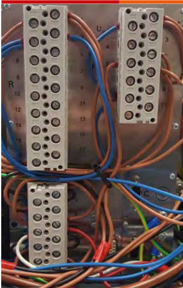
Abbildung 18 : Innenleben Rückseite Siprotec 7VE61
