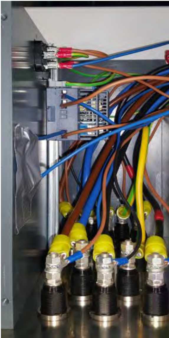
Abbildung 16 : Innenleben Buchsen und Hutschiene
