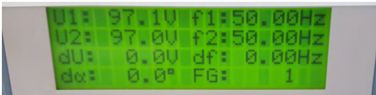
Abbildung 19 : Display-Anzeige der anliegenden Spannung
