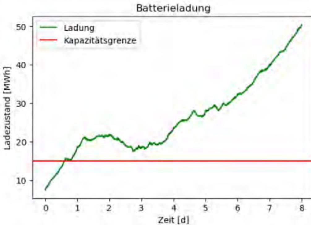
Abbildung 2 Frequenzgesteuerter Ladezustand (eigene Abbildung)
