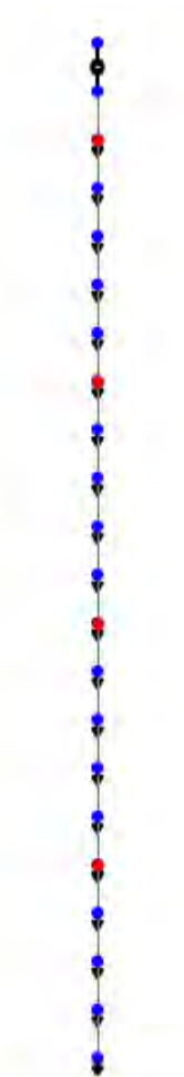
Abbildung 62: Netzstrang mit 20 Knoten und vier Ladestationen
