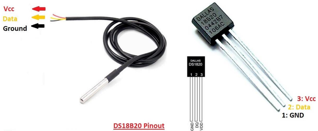
Abbildung 7 DS18B20 Pin Darstellung [13]
