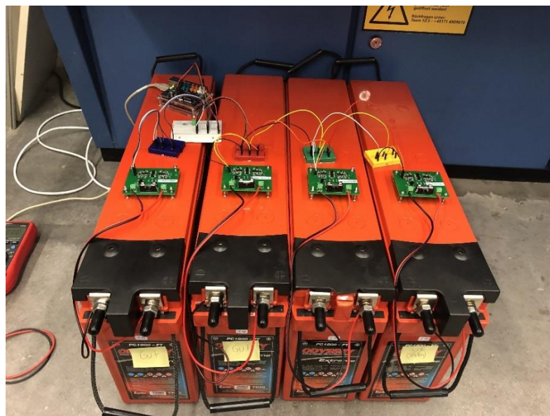
Abbildung 31 Aufbau von vier 1-WBM – Eigenes Bild
