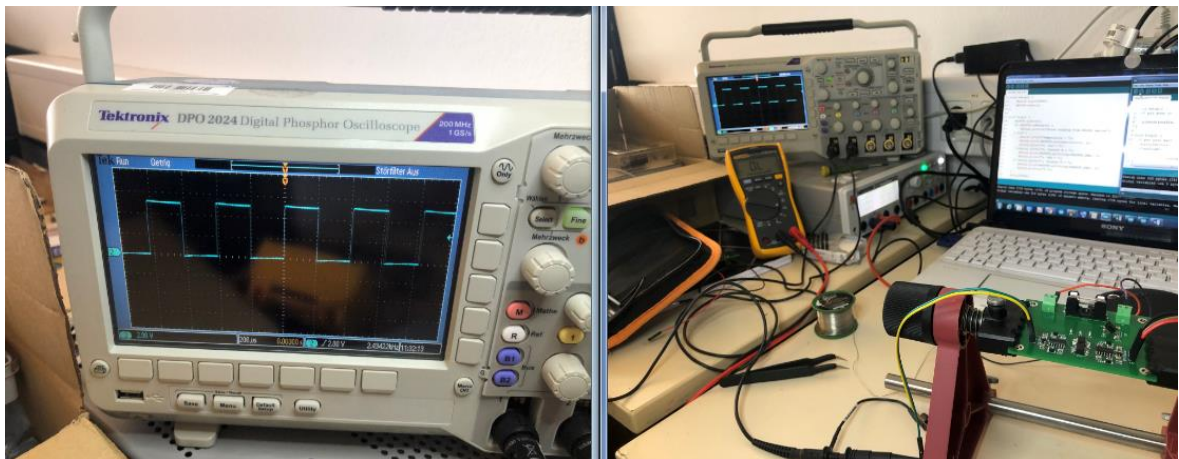
Abbildung 23 Prüftest von der 1-WBM mit einem Rechtecksignal – Eigene Bilder
