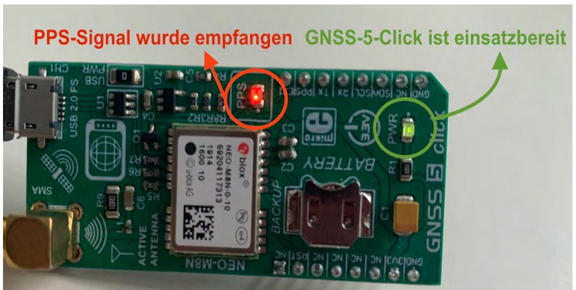
Abbildung 33: Das GNSS-5-Click hat das PPS-Signal empfangen (Markierung des Startpunktes der Zeitmessung) [35]
