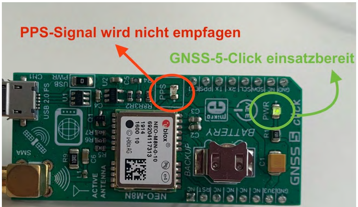
Abbildung 32: Das GNSS-5-Click Modul empfängt kein PPS-Signal [35]
