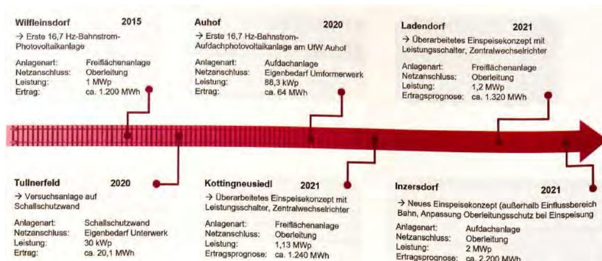
Abbildung 17: Überblick der verschiedenen Projekte zur PV-Direkteinspeisung der ÖBB [32]
