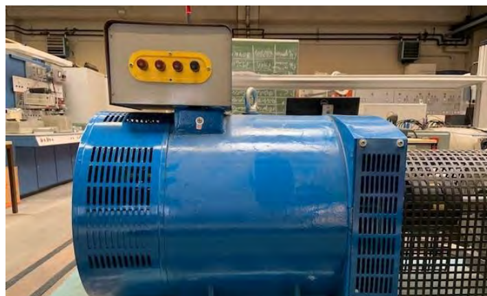
Abbildung 10 Vorderansicht der Synchrongenerator vor dem Umbau
