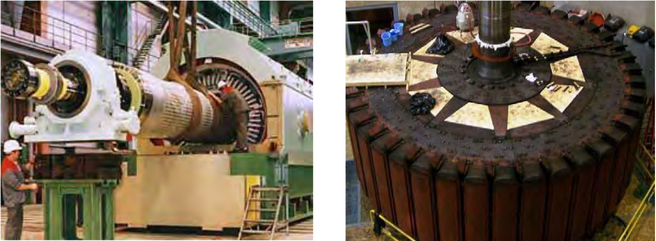
Abbildung 3 links Turbogenerator mit gezogenem Läufer; rechts Schenkelpolläufer Hoover-Staudamm
