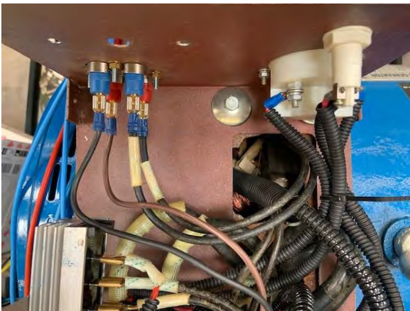
Abbildung 14 links Anschlüsse von Innen; rechts Anschlüsse der Gleichrichterdiode
