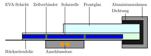
Abbildung 2.3: Schnitt eines typischen Siliziummoduls [11]
