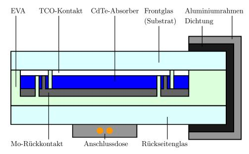
ABBILDUNG 2.4: Schnitt eines typischen Dünnschichtmoduls mit CdTe als Halbleiter [15]
