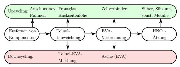
Abbildung 5.4: Recyclingprozess zur Erreichung einer hohen Upcyclingquote nach [73]
