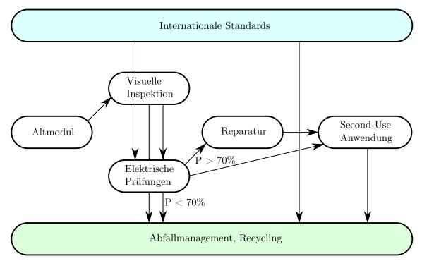
ABBILDUNG 5.1: Prozess für eine Second-Use Verwendung von Altmodulen nach [42]
