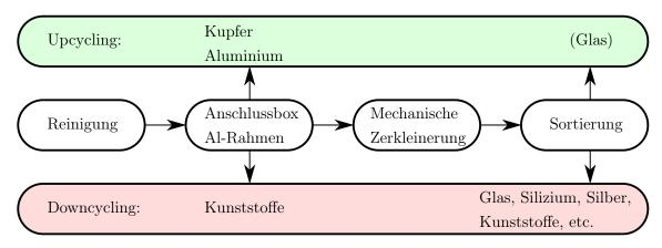
Abbildung 4.2: Aktuelle industriell zum Einsatz kommende Recyclingprozesse und daraus gewonnene Materialien [38, 51]
