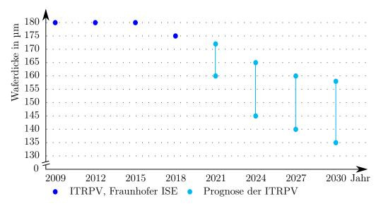
ABBILDUNG 6.2: Entwicklung der Waferdicke. Die Dicke der Wafer hängt von dessen Art ab, entsprechend sind Wertebereiche dargestellt. Daten aus [18, 48]
