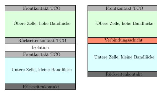
Abbildung 6.6: Tandemzellenkonzepte: Links eine Stapelung mit unabhängigem Einfachzellbetrieb. Rechts eine monolithische Tandemzelle mit Verbindungsschicht [88]
