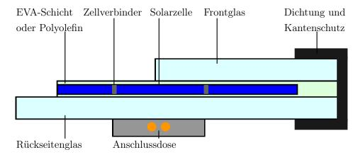
ABBILDUNG 6.5: Aufbau eines bifazialen Glas-Glas Moduls [85]
