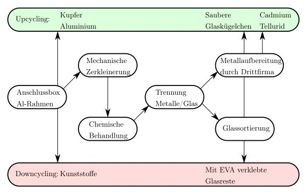
Abbildung 4.3: Aktueller industrieller Recyclingprozess von First Solar und daraus gewonnene Materialien [15, 54]
