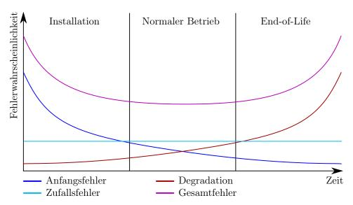
Abbildung 4.1: Qualitatives Prinzip der Fehlerwahrscheinlichkeiten während der Lebenszeit eines PV-Moduls [33]
