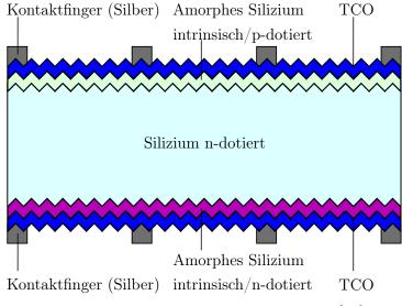
Abbildung 6.4: Aufbau einer HJT-Zelle [85]
