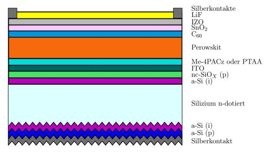
Abbildung 6.7: Beispielhafter Aufbau einer Tandemzelle aus einer Perowskitzelle und einer HJT-Siliziumzelle [88, 89, 90, 91, 94]
