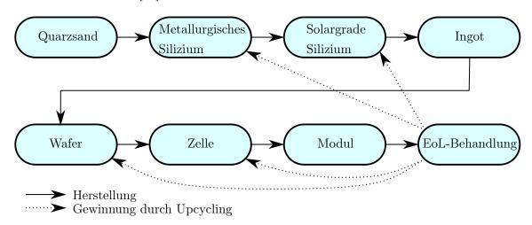
ABBILDUNG 5.5: Aufbereitung von Silizium für die Verwendung in PV-Modulen. [11, 52]
