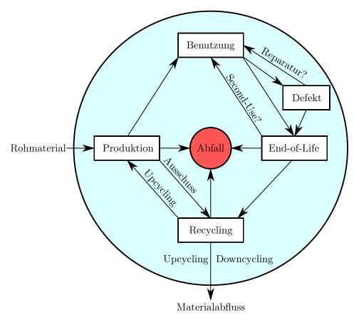
Abbildung 3.1: Kreislauf des Materialflusses bei PV-Modulen [16]
