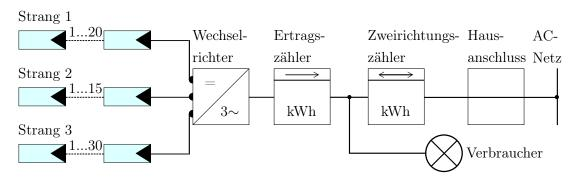
Abbildung 2.1: Beispielhafter Aufbau einer Solaranlage mit Standardkomponenten [11]
