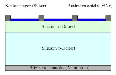
Abbildung 2.2: Schnitt einer Standard Siliziumzelle [11]
