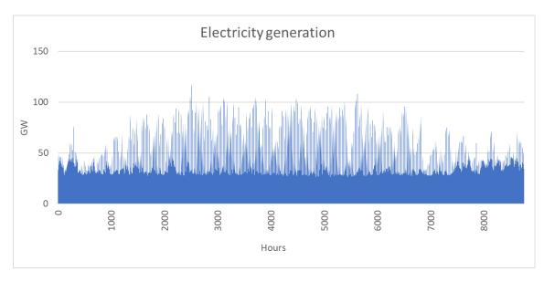
Abbildung 13 - Erzeugungsprofil EE - 2045 SZ 2-1
