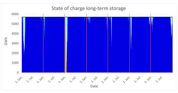
Abbildung 18 - Ladezustand Langzeitspeicher SC 2-1 bei verdoppelter installierter Erzeugung
