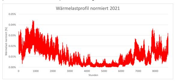
Abbildung 5 - normiertes Profil Strombedarf zur Wärmebereitstellung
